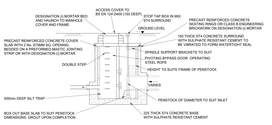
TYPICAL SECTION C-C TYPICAL HYDROBRAKE MANHOLE Scale 1:50
